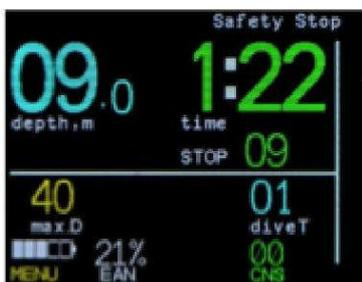
Contatore per la sosta di sicurezza
