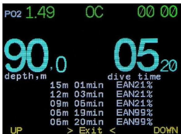
In immersione accedendo alla funzione Diveplan AV1 mostra il profilo decompressivo dell'immersione in corso.
