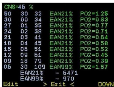
In qualsiasi momento dell'immersione è possibile consultare il piano di immersione con tutte le soste di decompressione future, tramite la funzione Dive Plan
